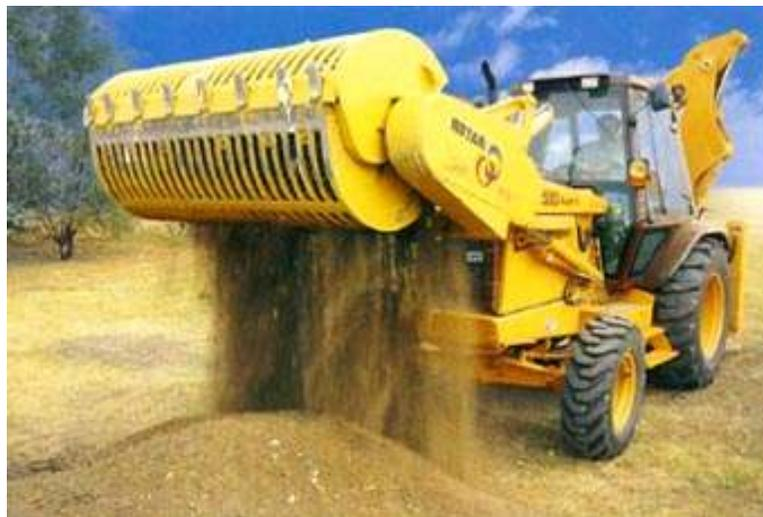
**Figure 3. COTS ROTAR<sup>®</sup> Soil Sifter**
